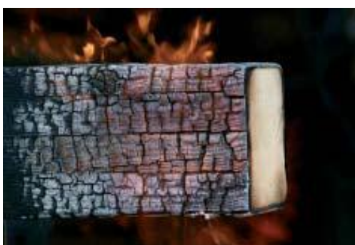
Figura 7.14 Element structural din lemn parțial carbonizat ( Fire safety in timber buildings, Technical guideline, 2010 )
